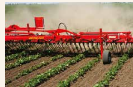
Zemljište bez žetvenih ostataka i suvo do radne dubine opružnih zuba, a korov u fazi nicanja optimalni su uslovi za upotrebu češljaste drljače.
