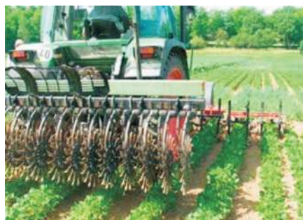
Fig. 24. Grapa rotativă (stânga) s-a dovedit a fi eficientă, în special, atunci când suprafața solului are crustă. Pentru plantele de soia mai mari se aplică, de obicei, o combinație dintre grapele cu cuțite plate și plivitorul cu deget (dreapta). La plantele mai mari de soia, se utilizează, de obicei, o combinație de măturări de gâscă și de mănăcăr de degete (dreapta)
