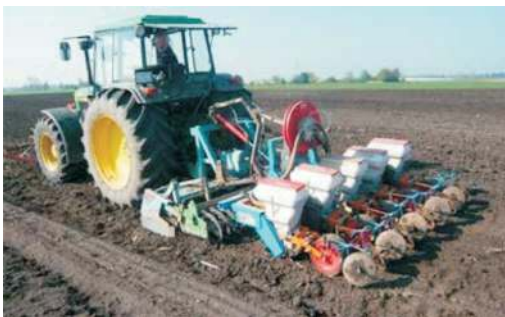
Fig. 19. La semănat, unii fermieri atașează ridicătoare mici, formând creștături de aproximativ 5 cm înălțime peste rândurile semămate. În acest caz, semințele de soia sunt semămate la o adâncime de numai 2-3 cm. Peste 3-4 zile după însămânțare, se realizează încă o lucrare mai „aspră” a solului, cu brăzdare, pentru a nivela din nou solul ridicat. Această metodă necesită o umiditate bună a solului pentru o apariție adecvată a plantelor de soia
