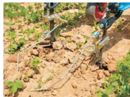
Fig. 21 La plantele tinere de soia, agregatul de torsiune este excelent pentru îndepărtarea buruienilor de pe rând. Plivitoarele comune sunt folosite pentru buruienile dintre rânduri
